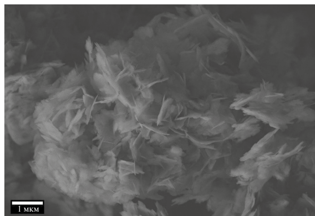
Рис. 2. РЭМ-изображения синтезированного цеолита MCM-22.
